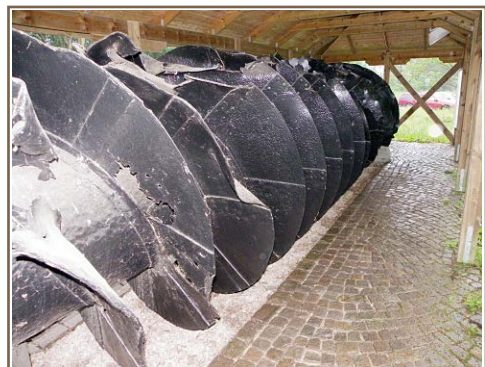
Arkimedesskruven som användes i slutet av 1800-talet för att torrlägga Nosabysjön, Kristianstad. Skruven drevs med en ångmaskin.
